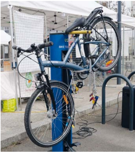
→ Les deux barres au sommet de la borne permettent d'accrocher votre vélo pour le réparer. On peut aussi le glisser entre la borne et la barre latérale.
