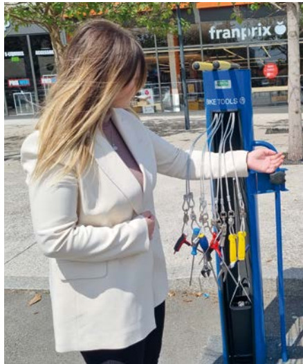
→ On fait glisser le volet et voici dix outils à disposition reliés à la borne par un câble d'acier : tournevis, clé, pinces, leviers, etc. La pompe à air se trouve à la base du dispositif.
