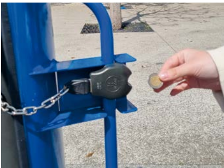
→ Pour ouvrir la borne, on glisse une pièce dans le monnayeur. Ensuite, on peut dégager la chaîne qui ferme la borne.
