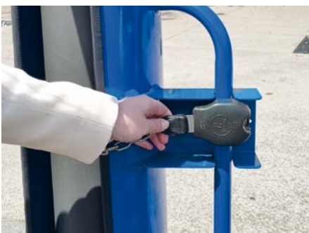
→ Pour ouvrir la borne, on glisse une pièce dans le monnayeur. Ensuite, on peut dégager la chaîne qui ferme la borne.
